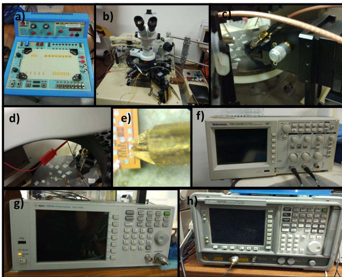
Figura 66- a) Fonte de alimentação para o teste dos circuitos b) setup montado para o teste do chip elaborado c) e d) probes de teste e de radiofrequência e) probe de radiofrequência f) osciloscópio g) gerador de sinais de radiofrequência h) analisador espectral.
