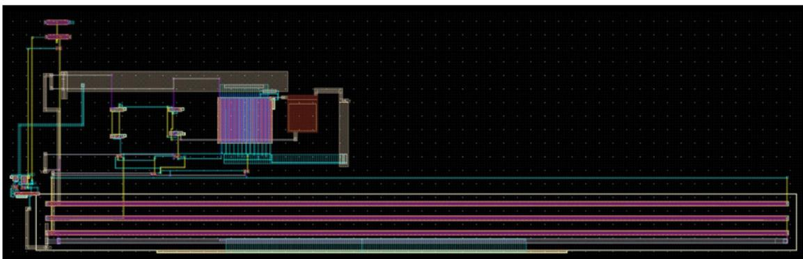
Figura 62- *Layout* do relógio implementado para ligar o chip (dimensões 90 x 290  $\mu\text{m}^2$ ).
