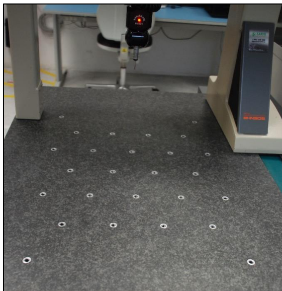
Figura 4.18 – Furação da base de granito da CMM1
