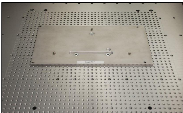
Figura 4.35 – Colocação do jig da blenda na CMM
