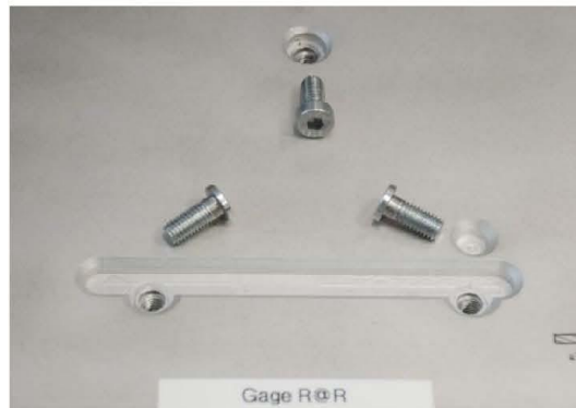
Figura 5 – Aparafusamento do jig
