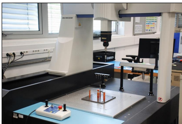
Figura 4.20 – CMM2 após a colocação da nova base fixa
