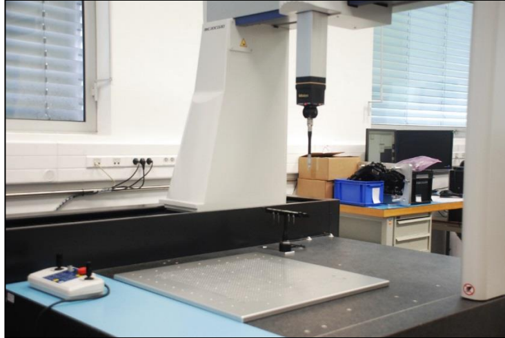
Figura 4.21 – CMM3 após a colocação da nova base fixa
