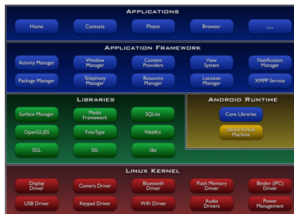
Figura 8: Arquitetura do sistema Android[23]
