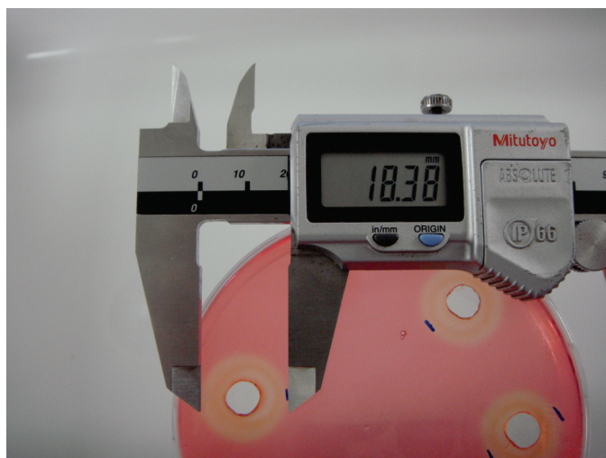
Fig. 2. Determinação com paquímetro do diâmetro de um halo de hidrólise em ensaio de difusão radial em gel de agarose (DRGA) com 1% de carboximetilcelulose e corado com vermelho congo 0,1%.
