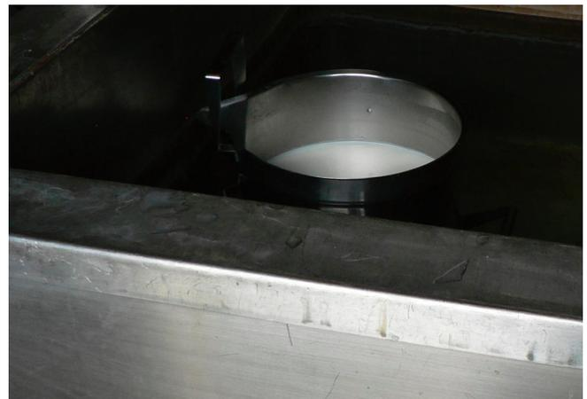
Fig. 3. Pasteurizar o leite utilizando sistema Banho Maria a temperatura de 62 a 65 °C por 30 minutos.
