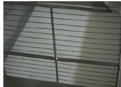
Fig. 7. Corte a coalhada com a lira horizontal no sentido longitudinal
