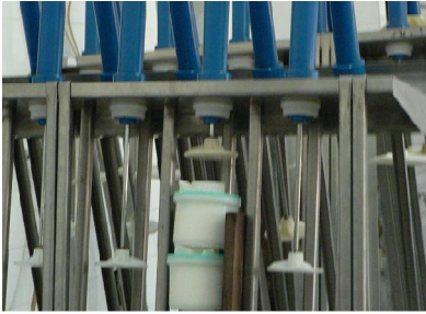
Fig. 21. Prensa a massa por cerca de 12 horas utilizando 0,5 libras para 10 kg de massa
