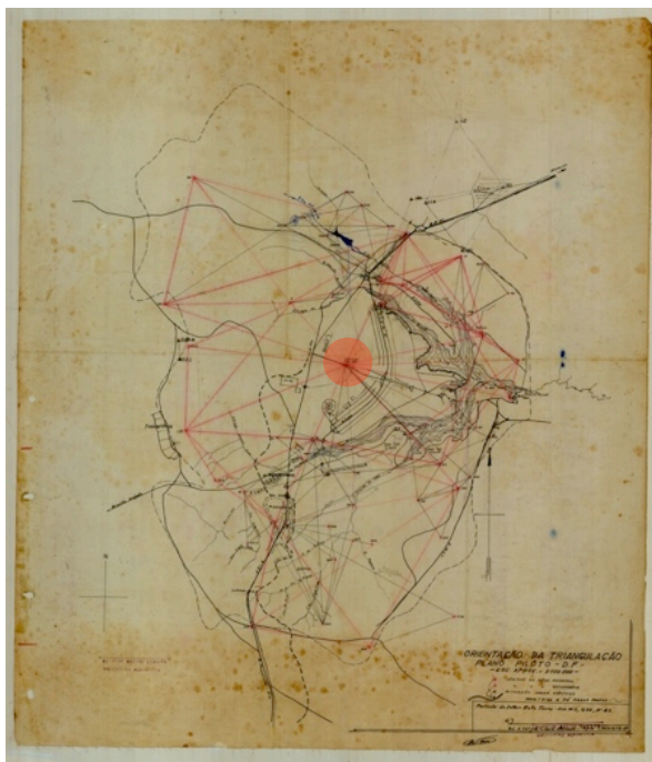
Figura 16. Orientação da triangulação Plano Piloto – D.F. esc aprox. 1:100.000, sd. Jethro Bello Torres, eng. Agrimensor (fonte: ArPDF). Cruzeiro | V8 - assinalado a vermelho (CEEAUM)
