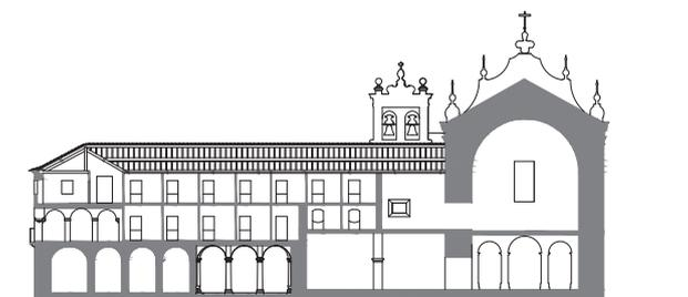
FIGURA 19 Síntese | corte longitudinal da ala sul do convento
