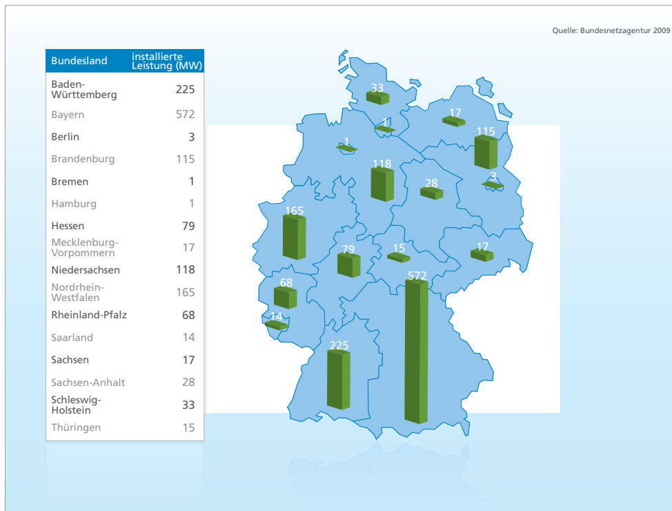
< Grafik 4: Von Januar bis September 2009 bei der Bundesnetzagentur gemeldete installierte PV-Anlagenleistung pro Bundesland in MW >
