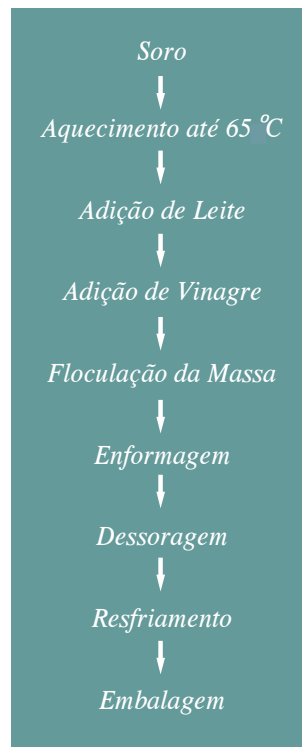
Fig. 1. Fluxograma do processamento da ricota.
