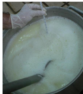
Fig. 2. Aquecimento do soro a 65 °C sob agitação.
