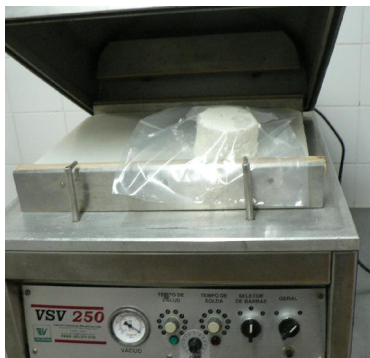
Fig. 9. Embalagem a vácuo da ricota.
