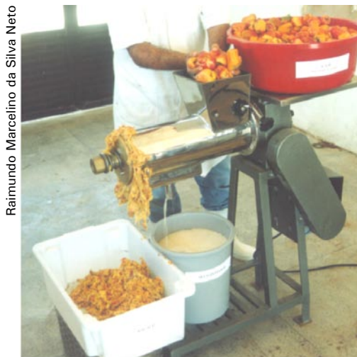
Figura 6. Extração do suco com a prensa expeller .
