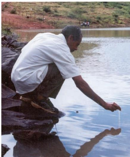
**Figura 20.** Forma correta de mergulhar a pipeta na água.
