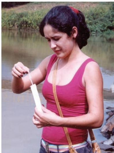
**Figura 19.** Cuidados na retirada da pipeta da embalagem protetora.
