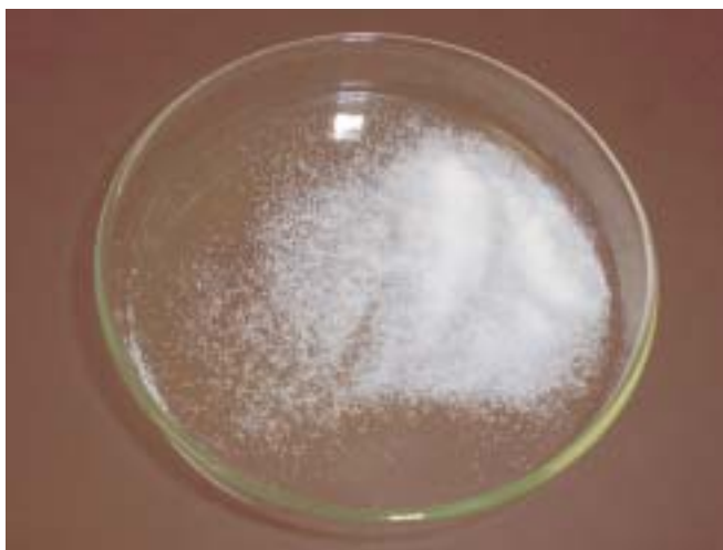
Fig. 2. Fotografia do suporte (sílica macroporosa) utilizado neste trabalho para imobilização da tanase.
