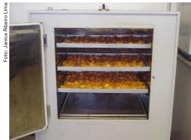
Fig. 3. Melão. Secagem em estufa com circulação forçada de ar.
