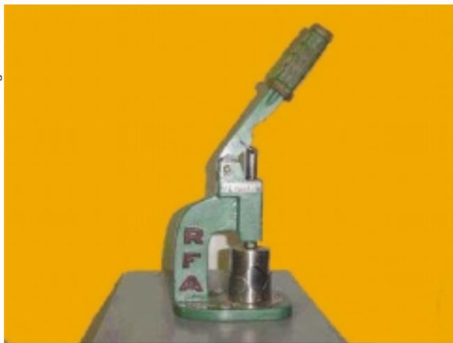
Fig. 1. Máquina descastanhadora.
