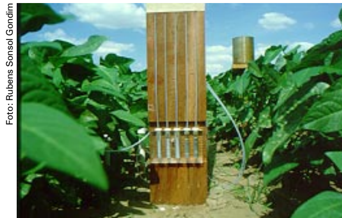
Fig. 4. Bateria de tensiômetros de mercúrio instalados em cinco profundidades.
