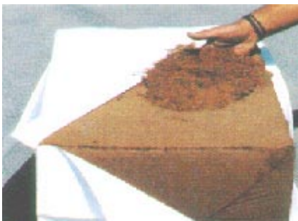
Fig. 3. Ladrilho prensado de pó de coco seco. Fonte: PROJAR [199-?]
