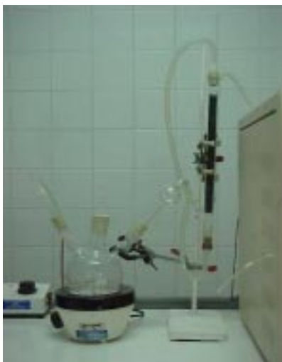
Fig. 5. Sistema de umidificação, aquecimento e filtragem do ar que vem do cilindro para arrastar os compostos voláteis até as narinas do julgador.
