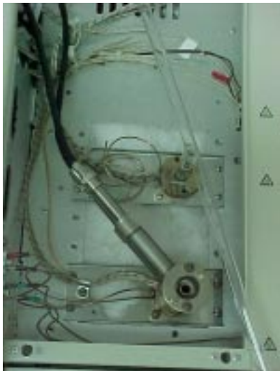
Fig. 3. Vista superior do encaixe do tubo de vidro sobre a saída da coluna.
