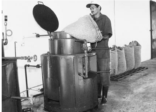
FIG. 5. Sistema de autoclavagem da castanha em vaso cozedor.
