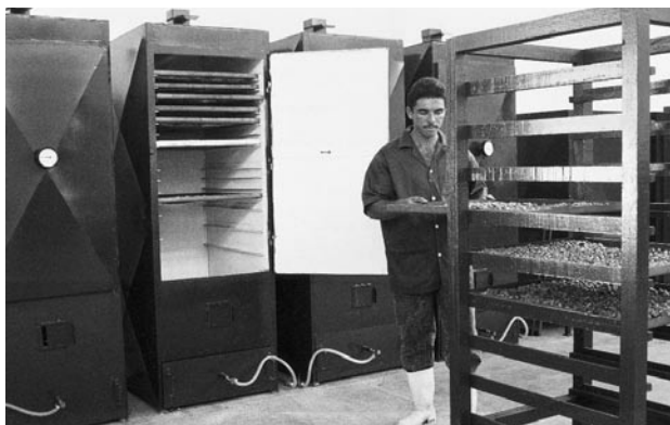
FIG. 7. Estufa à gás para a desidratação da amêndoa.
