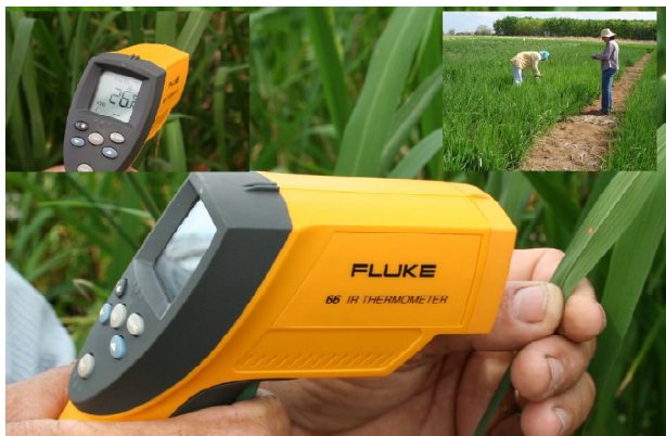
Fig. 5. Avaliação da temperatura das folhas com o termômetro de infravermelho.
