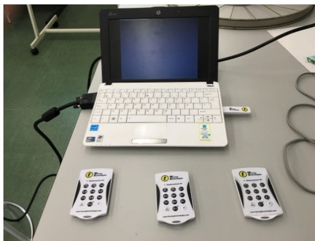
Figura 1. Equipo utilizado: portátil, tarjeta receptora y mandos de respuesta.
