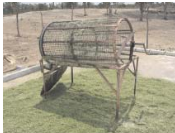
Fig.21. Peneira rotativa utilizada para separar a bucha da mucilagem do sisal.
