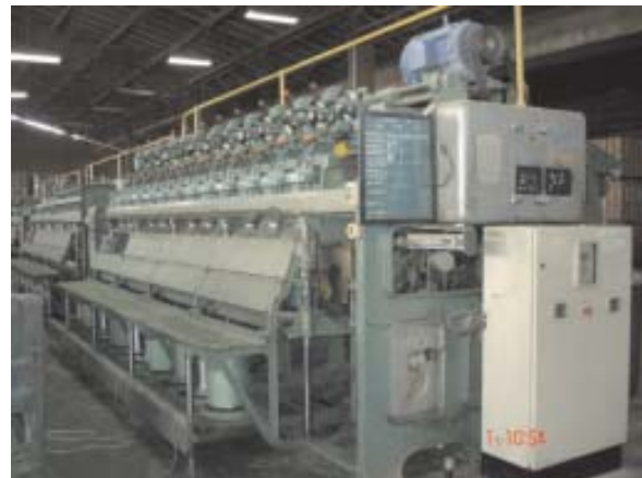
Fig. 19. Vista de uma "fiadeira" em produção do baler twine .
