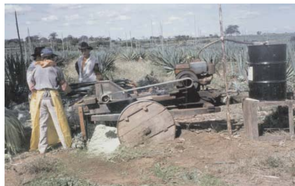
Fig. 14. Máquina Paraibana desfibrando folhas de sisal em regiões produtoras do Estado da Paraíba.
