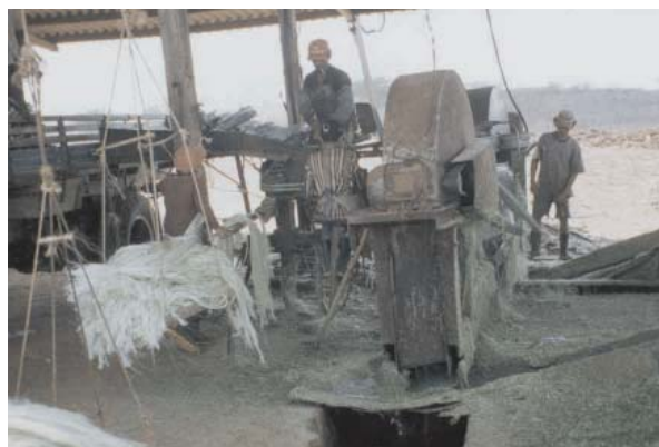
Fig. 16. Protótipo Nova Floresta para o desfibramento do sisal.
