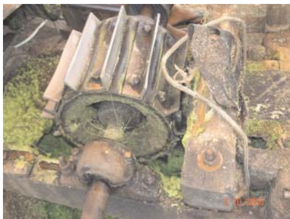
Fig. 15. Detalhe da madeira ou cepo colocada próximo ao rotor.
