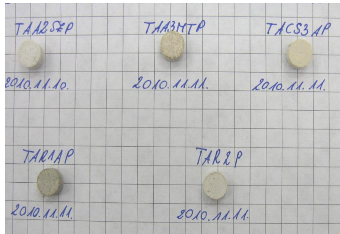
12. kép. RFA-ra előkészített pasztillák
