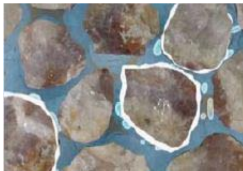
3. ábra: CO 2 (világos), homokkő ásványszemcséi (szürkés), sós pórusvíz (sötét) és a kivált karbonát (fehér) (Arts et al., 2008 fordította: Hartai, 2009).
