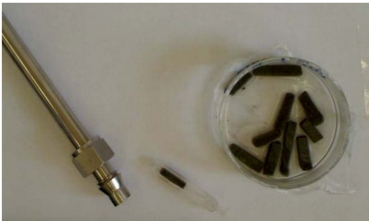
13. ábra: Az 5w/w%-os NaCl-oldatban ázó kőzet minták, a mintatartó üvegcsónak és a "bomba".
