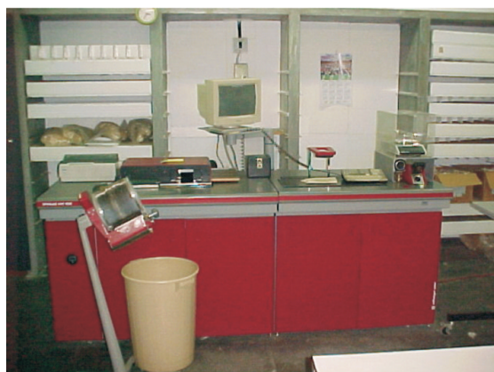
Fig. 1. Observa-se o equipamento HVI modelo 900 da USTER em funcionamento, no Laboratório de Tecnologia de fibras e Fios da Embrapa Algodão
