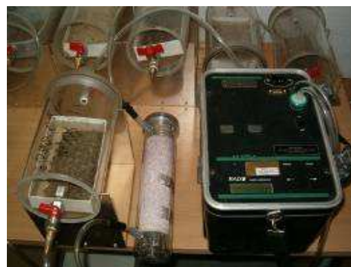
RAD7 radonmonitorral történő mérés [2].
