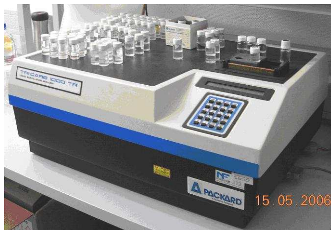
3. ábra Tri-Carb 1000 típusú folyadékszintillációs spektrométer
