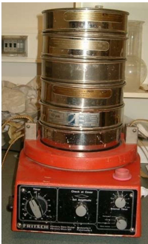
16. ábra. A hattagú szitasor a rázógépen
