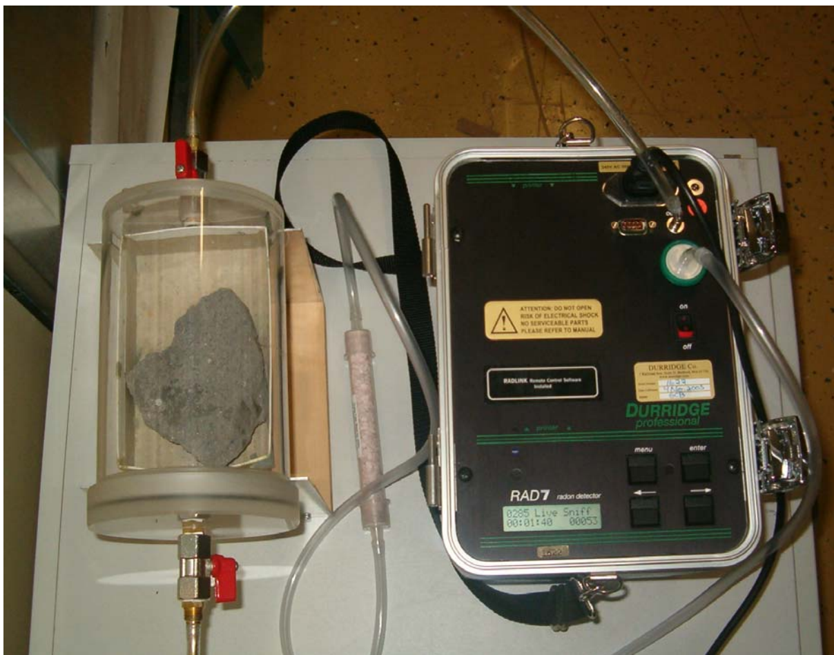
12. ábra RAD 7 detektor, a gázszilikát minta mérése közben
