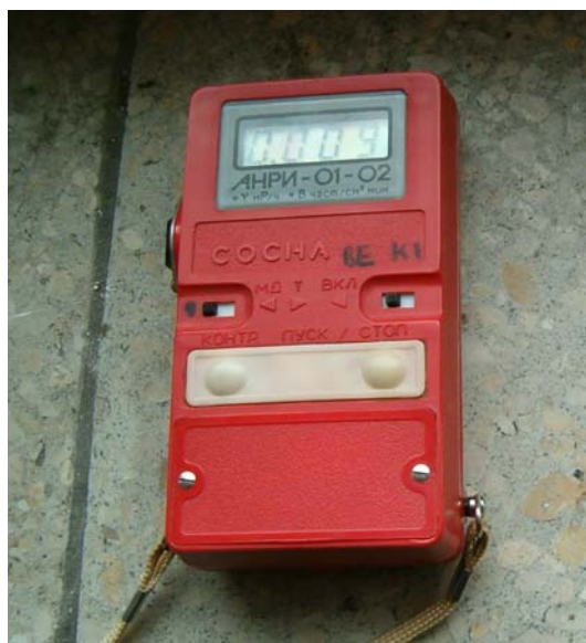
11. ábra A doziméter a csempe 1 (CS1) mérése közben
