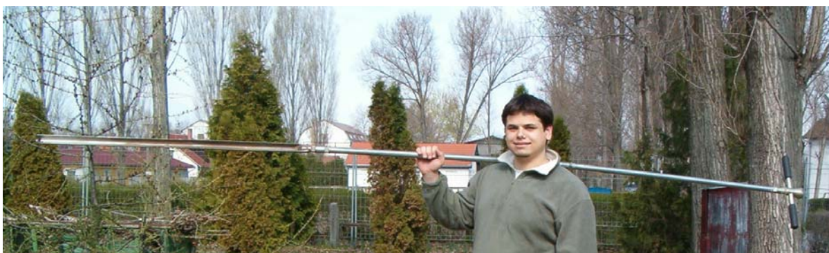
15. ábra A talajkézfúró (tartja az egyik szerző)
