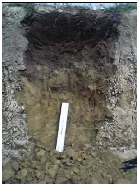
4. kép: Tass, vályoggödör szelvénye, a vonalzó 20 cm-es
