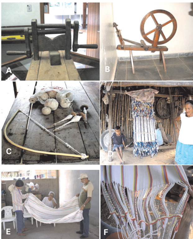
Fig. 9. Equipamentos usados na fiação e tecelagem da fibra de G. barbadense e redes artesanais produzidas. A) Descaroçador de rolo; B) Roca; C) Fusos, batedor e novelos; D) Tear; E) Rede; F) Detalhe da rede
