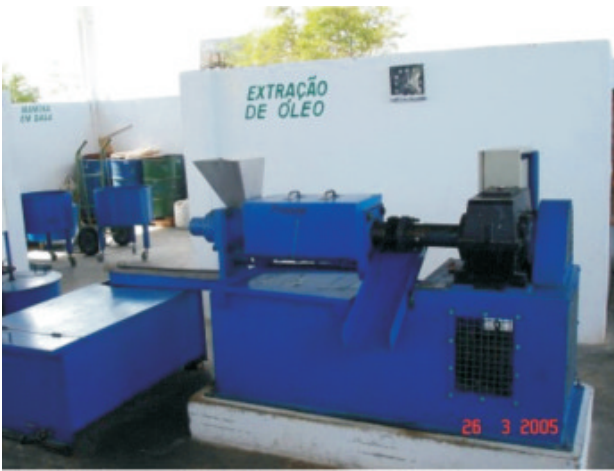
Fig. 3. Prensa para la extracción de aceite de tártago en mini-plantas.
