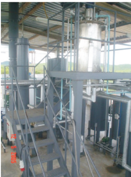
Fig. 4. Mini-planta de biodiesel para producción en pequeña escala.
