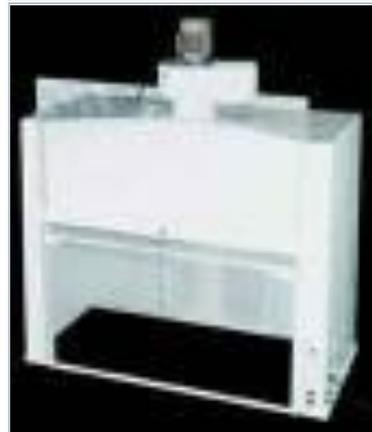
Local fechado, dotado de um exaustor onde se realizam as reações que liberam gases tóxicos num laboratório.
