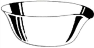
Usada em evaporações, dissoluções a quente, calcinação, secagem e aquecimentos.
