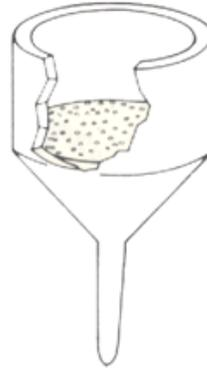
Recipientes de porcelana de diferentes diâmetros. Na sua parte interna se coloca um disco de papel de filtro. Utilizado para realizar filtrações à vácuo.
