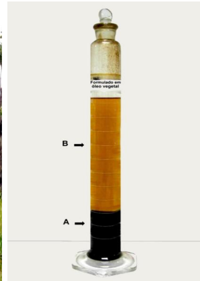
Figura 3. Conídios de M. anisopliae var. acidum (A) em óleo de soja(B), depositados no fundo do recipiente.
