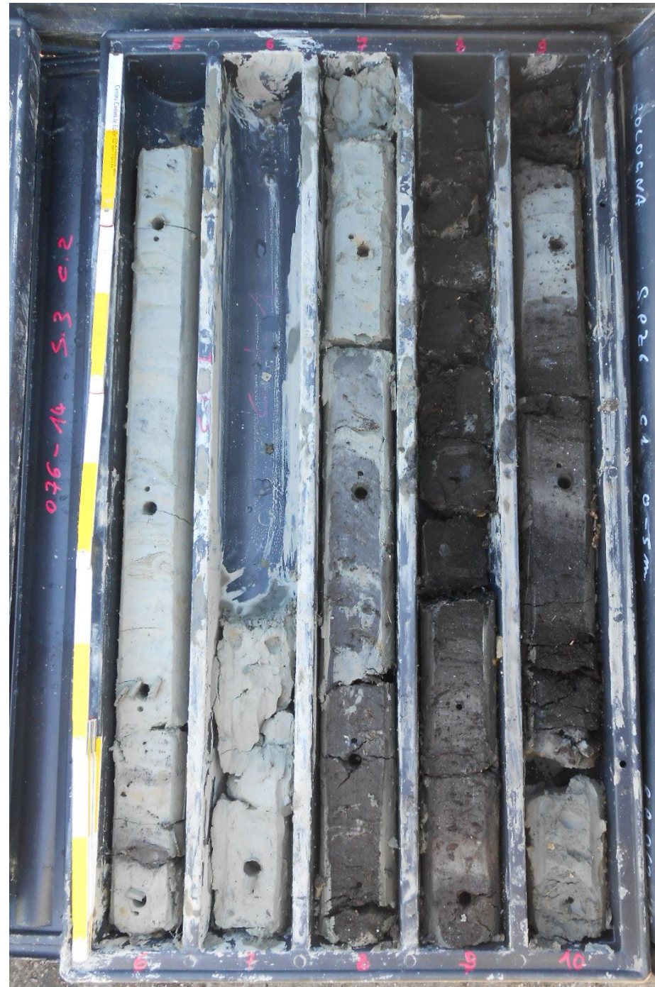
Esempi di carotaggi in terreni di argine e piana alluvionale (limoso sabbiosi argillosi e con s.o.)
