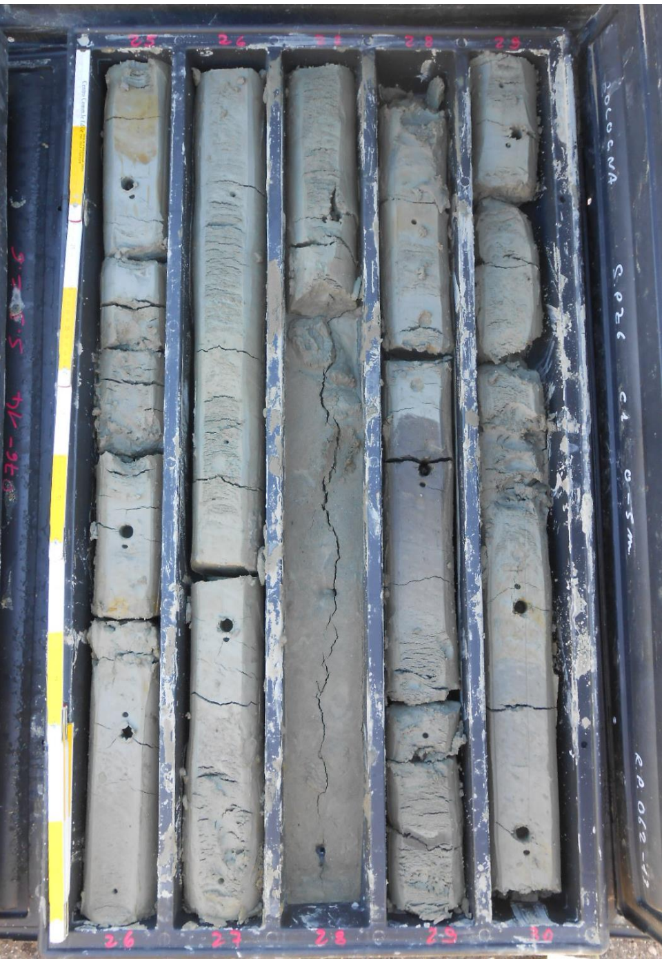
Esempi di carotaggi in terreni di argine e piana alluvionale (limoso sabbiosi argillosi e con s.o.)
