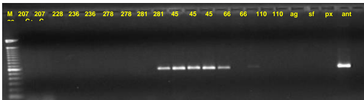
Figura 14 – Reações de SCAR com o primer BT-BR1. Os números indicam: 207, A. cocois ; 228, A. aepim ; 236, B. tuberculata ; 278, A. woglumi ; 281, T. vaporariorum ; 45 e 66, B. tabaci biótipo BR; 110, B. tabaci biótipo B; ag, A. gemmatalis ; sf, S. frugiperda ; px, P. xylostella ; ant, A. grandis ; ae; A. aegypti ; C+, seqüência do primer BT-BR1 clonada no plasmídio pBEM-BR2; C-, corresponde ao controle negativo feito com água. A letra M refere-se ao marcador de massa molecular 100 pb ladder.
