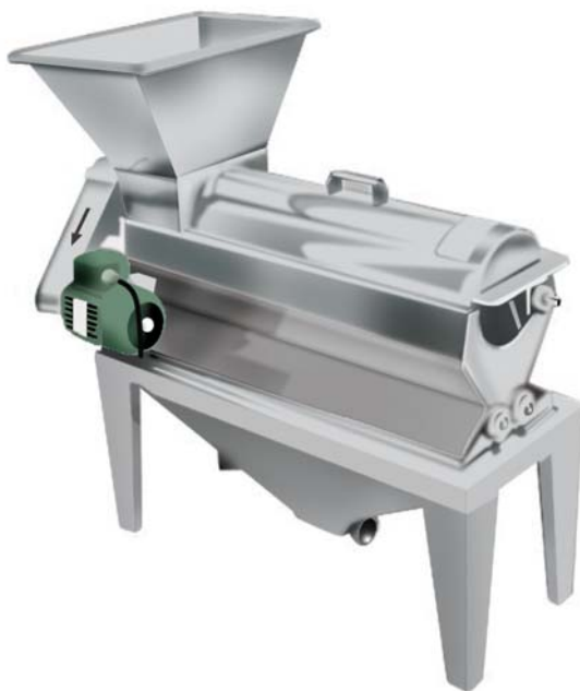
Fig. 2. Máquina desengaçadeira-esmagadeira para separar a ráquis e esmagar a uva.
