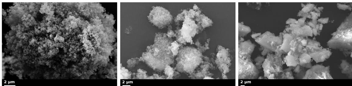
**Abbildung 3.8:** SEM-Aufnahmen der Silikatquellen Microsilica (links), des Filtrerrückstandes (Mitte) und der Reisschalenasche (rechts).
