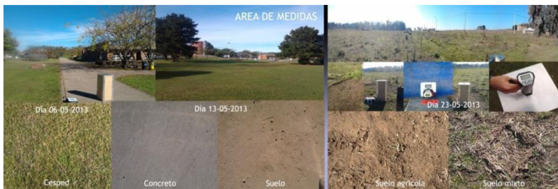
FIGURA 30: Superficies utilizadas para la toma de datos con la caja de emisividad, donde se encuentran también la estación de balance de energía.
