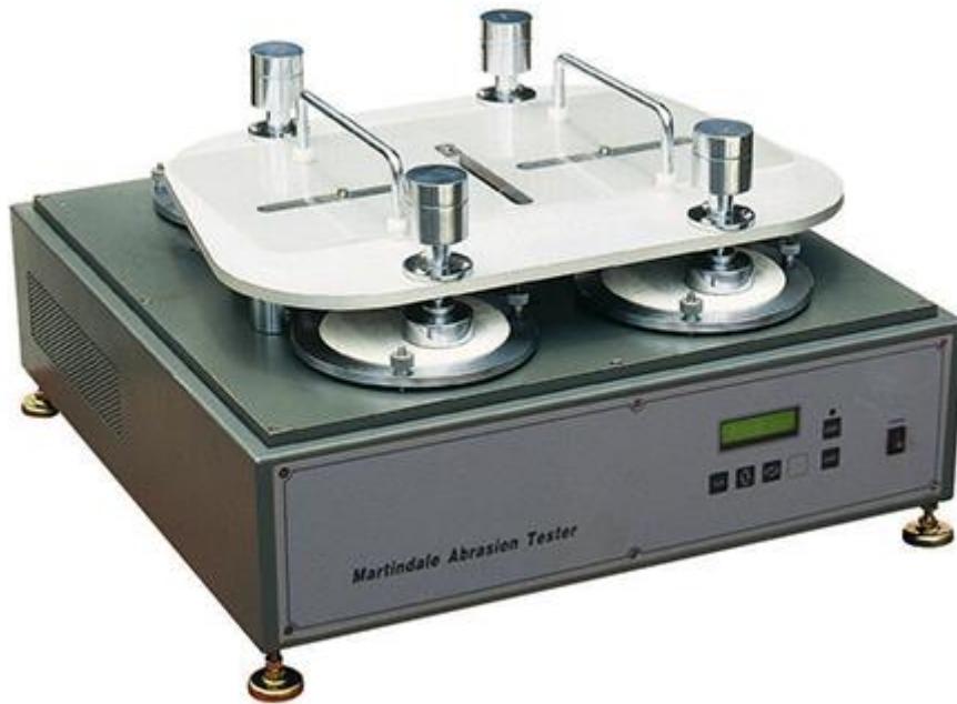
Figura B.1 – Exemplo do equipamento “Martindale”
