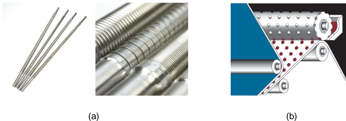
Figura 3.1 – Rolos em espiral (a) e esquema do rolo de mil pontos (b)
