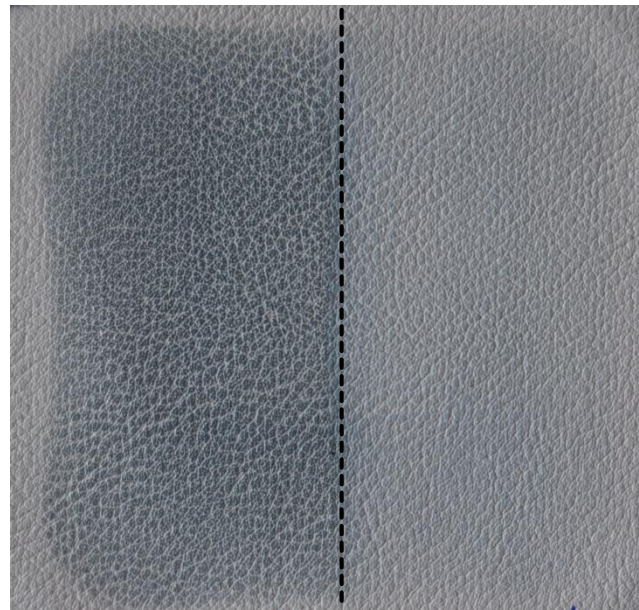
Figura 4.8 - Resultado do ensaio R3.2 antes da limpeza (a) e depois da limpeza (b)
