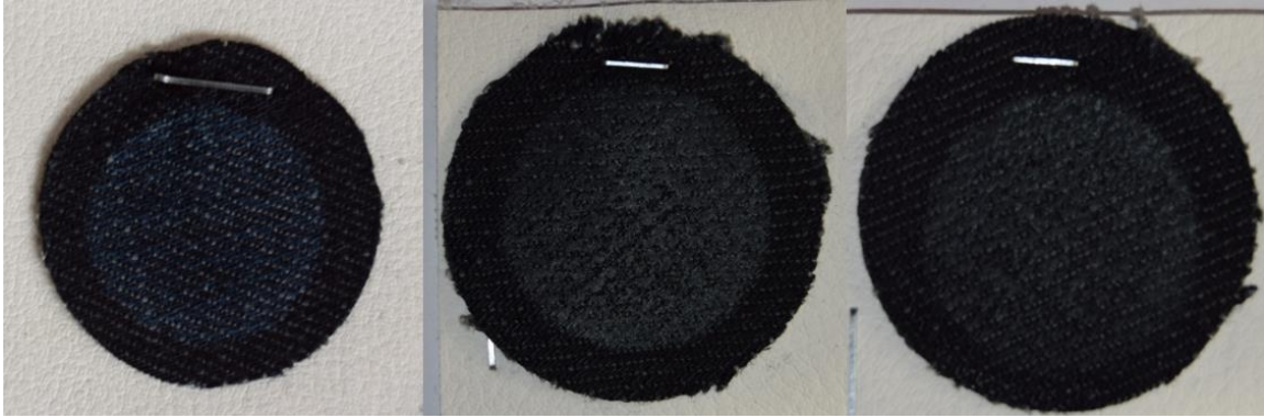
Figura 4.26 – Amostra da ganga referência (a), amostra da ganga do ensaio S2.1 (b) e amostra da ganga do ensaio S2.2 (c)
