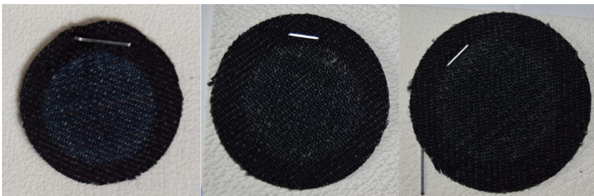
Figura 4.23 - Amostra da ganga referênci (a), amostra da ganga do ensaio L3.1 (b) e amostra da ganga do ensaio L3.2 (c)
