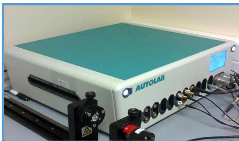
**Figura 14** Potencióstato/galvanostato Metrohm PGSTAT302N
