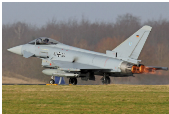
Figura 1 – O Eurofighter Typhoon tem grande parte das suas asas e fuselagem construídas em materiais compósitos de fibras de carbono. [42] - [43]
