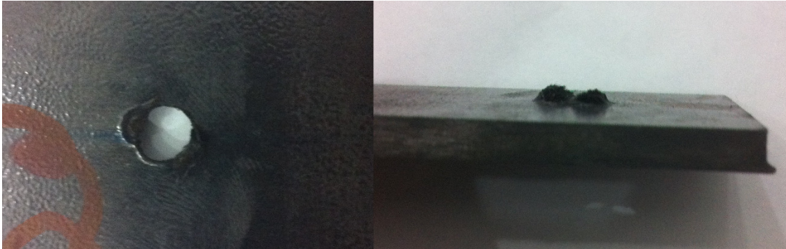
Figura 49 – Levantamento volumoso de fibras após furo com broca HSS.
