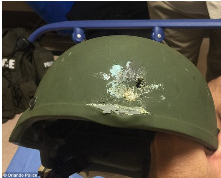
Figura 6 – Capacete em Kevlar® utilizado pelas forças especiais da polícia de Orlando, EUA, após sustentar um impacto de bala, salvando a vida ao agente. [48]
