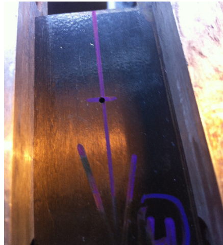
Figura 31 – Provetes 135_4 após o furo prévio da furação HPF, a 30 mm da face.
