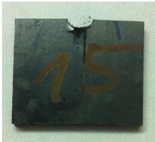
Figura 44 – Provede 135_15 após ensaio Pin-Bearing , sendo visível a fratura vertical.
