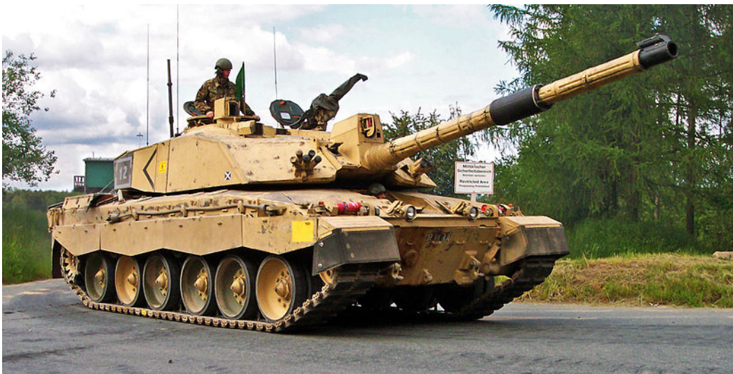
Figura 5 – A blindagem Chobham do tanque britânico Challenger 2 é um compósito de matriz metálica e reforço cerâmico. [47]
