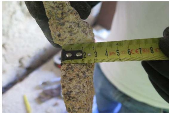
e) Profundidade do cone de alvenaria
