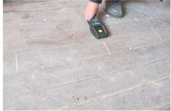
c) Determinação do alinhamento das vigas através do detetor de metais.
