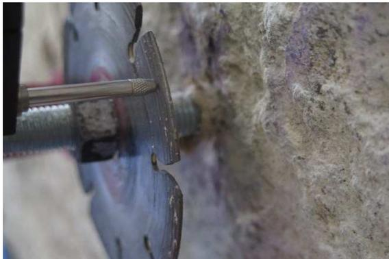
c) Componente auxiliar do aparelho: disco de aço.
