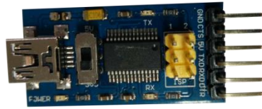
Figura 25 - Modulo adaptador USB para Série, FTDI - FT232RL.
