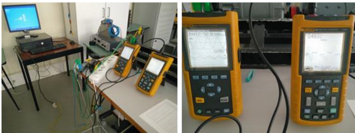
Figura 50 - Montagem em laboratório para teste a alimentar uma fonte comutada.
