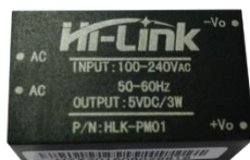
Figura 24 - Modulo AC/DC Hi-Link HKL-PM01.
