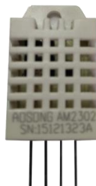
Figura 19 - Sensor de humidade relativa e temperatura com saída digital DHT22.
