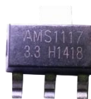
Figura 23 - Ilustração do AMS1117 da Advanced Monolithic Systems .
