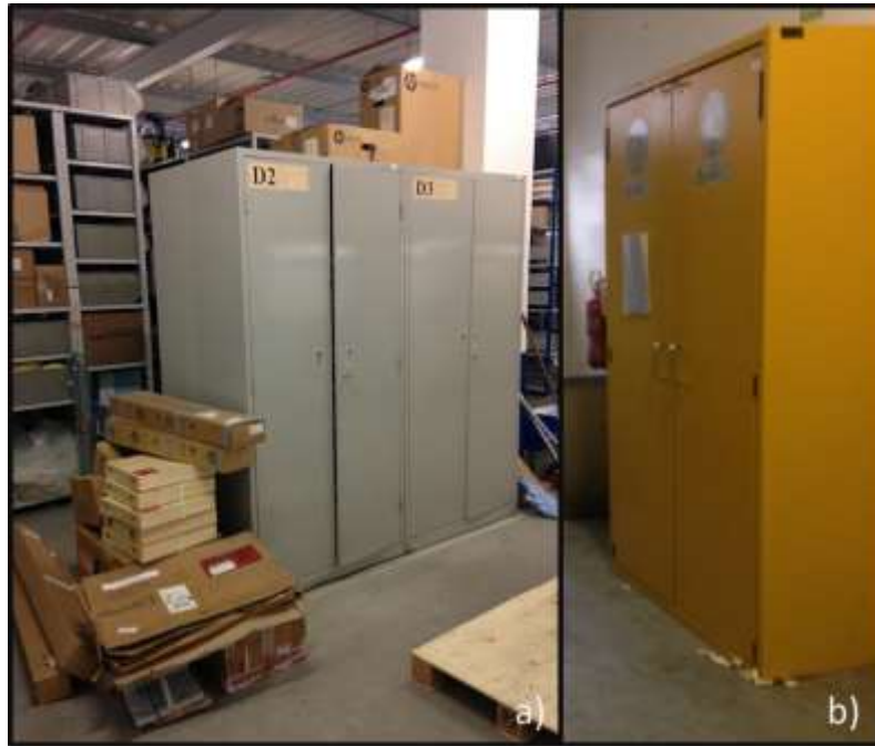
Figura 18 Armários existentes em armazém em que a) armários convencionais, b) armário corta-fogo
