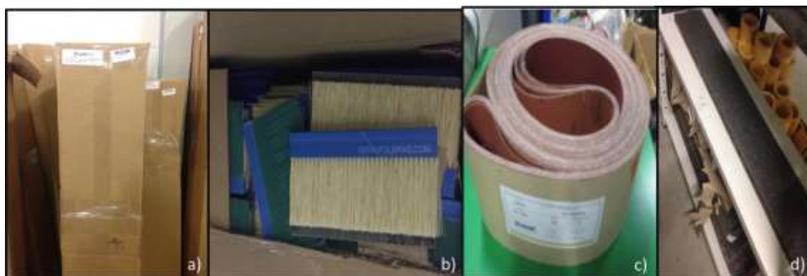
Figura 61 Vários tipos de consumíveis que estão diretamente ligados às máquinas durante o processo de fabrico em que a) escovas de polimento, b) tira de lixa c) cinta de lixa, d) recarga de patins de lixa
