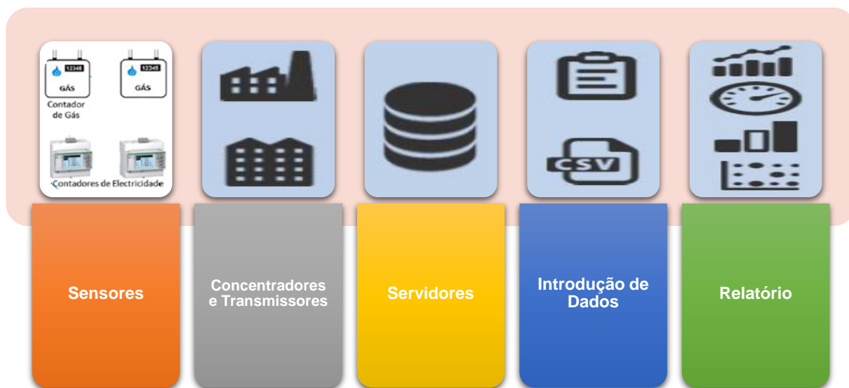
Figura 38 – Exemplo do Sistema de Monitorização e Reporte de Energia utilizado. [adaptado de [12]]
