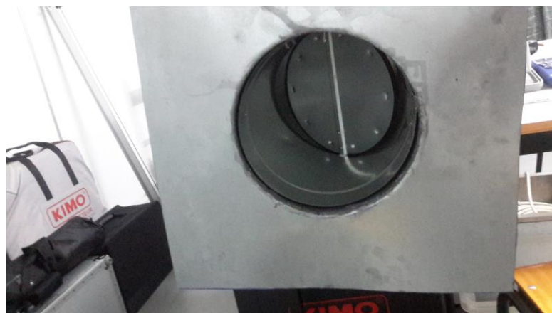
Figura 69 - Equipamento construído para realização de ensaios, pormenor da válvula de regulação de caudal
