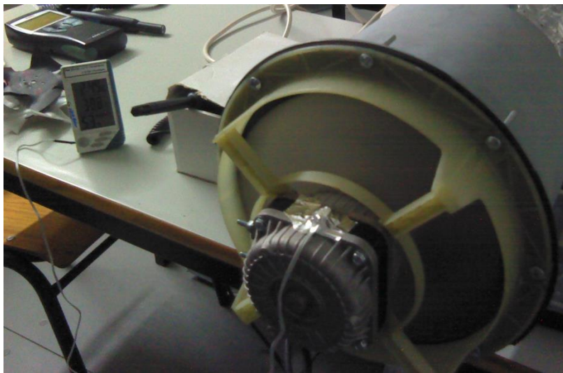
Figura 70 - Termo higrómetro com sensor acoplado ao motor de polos sombreados.
