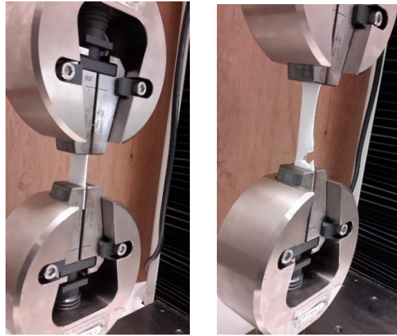
Figura 52 - Ensaio de tração de um provete do material B
