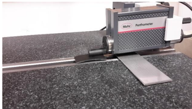
Figura 64 - Medição de rugosidades no provete mo material P.
