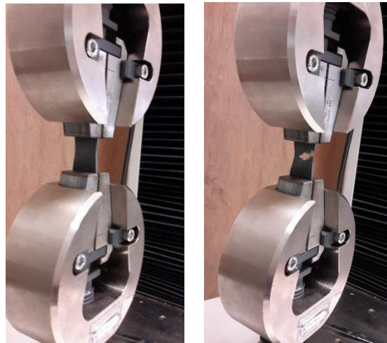
Figura 53 - Ensaio de tração de um provete do material P
