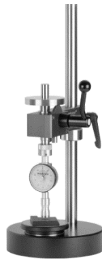
Figura 27 – Durómetro, equipamento utilizado para ensaios de dureza Shore. [10]
