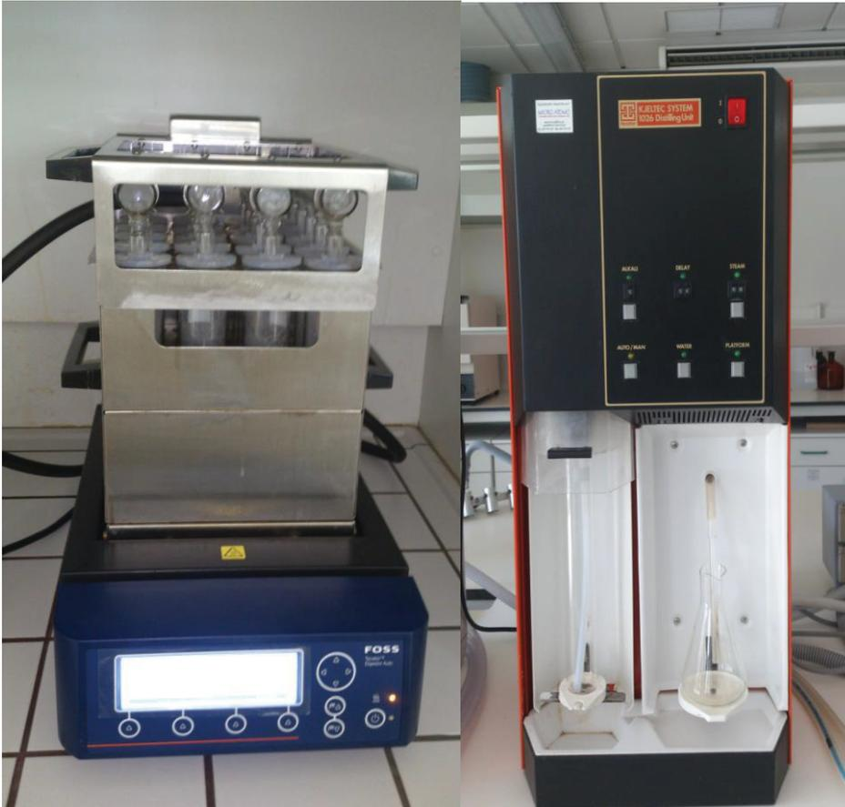
Figura 10 - Extrator Kjeltec
