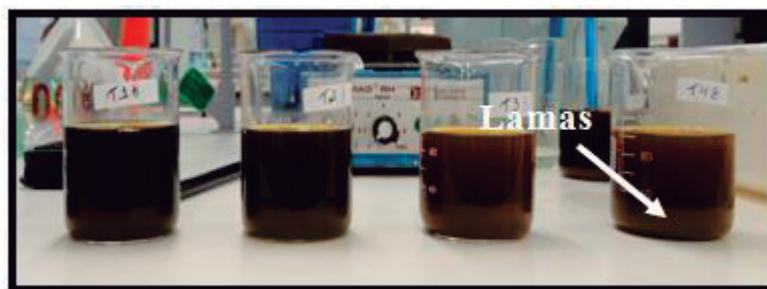
Figura 5. Características visuais do efluente e das lamas obtidas no tratamento de água residual da vinhaça
