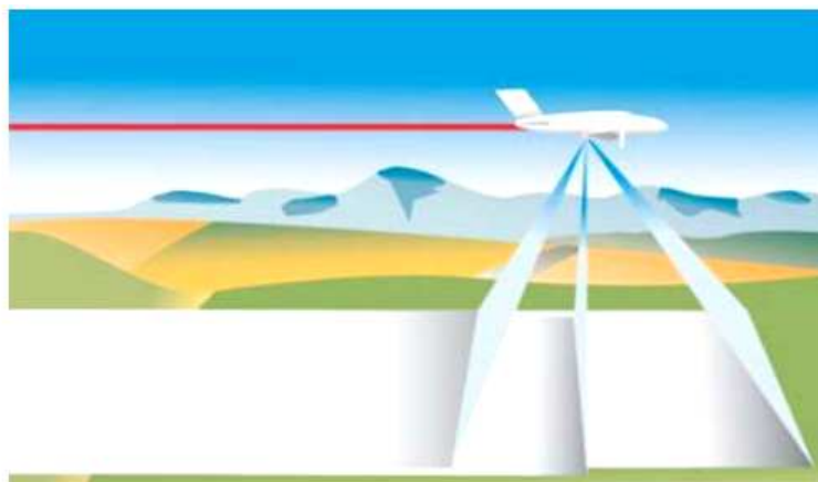
Рисунок 1. – Принцип работы линейного ПЗС-приемника
