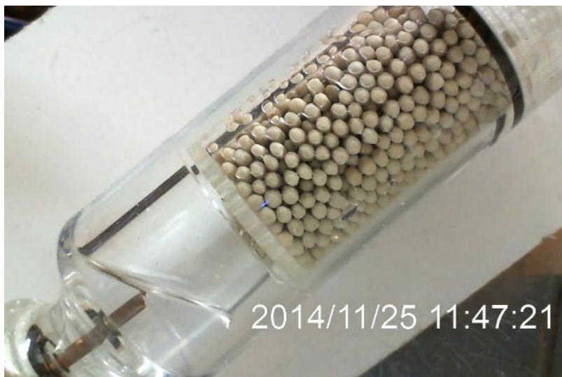
Figura A.12 – Vista interna do filtro secador com tubo capilar inserido (foto do autor).
