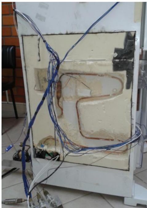
Figura A.16 – Aspecto do procedimento de troca do conjunto tubo capilar-linha de sucção.
