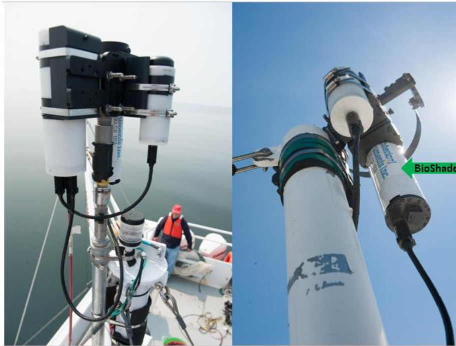
Figure 2-6: Prise de mesure de l'éclairement descendant ( E_d ) et le BioShade près de la bouée IML-4 à l'aide d'un radiomètre installé sur le bateau (juillet 2015), (crédit photo : Gabriel Ladouceur).
